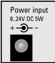
Stromversorgung des Geräts. Verwenden Sie nur das mitgelieferte Steckernetzteil oder eines mit der angegebenen Spannung, Leistung, Polarität und passendem Steckertyp (siehe [11. Technische Daten](#)) Der Anschluss ist verpolungssicher ausgeführt, falls beim Anschluss eines Netzteils die „Power“-LED nicht leuchtet, überprüfen Sie die Polarität.
