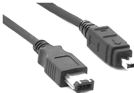
Abb 4-10: 4- und 6-polige Steckervariante für eine IEEE 1394-Verbindung [kbsinc.com]
