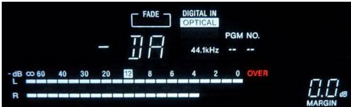
Abb 4-19: Pegelanzeige eines DAT-Recorders beim Abspielen des Signals aus Abb 4-11. [SCHUBERT]
