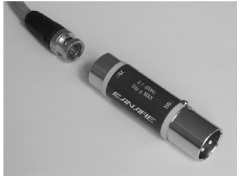
Abb 4-3: Interface nach AES3-id mit Impedanzanpassung an AES3 [WEINZIERL]
