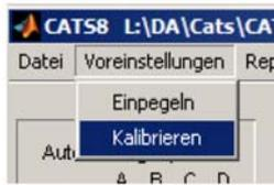
Der Kalibriervorgang wird mittels der Funktion *Kalibrieren* unter dem Menüpunkt *Voreinstellungen* gestartet.
