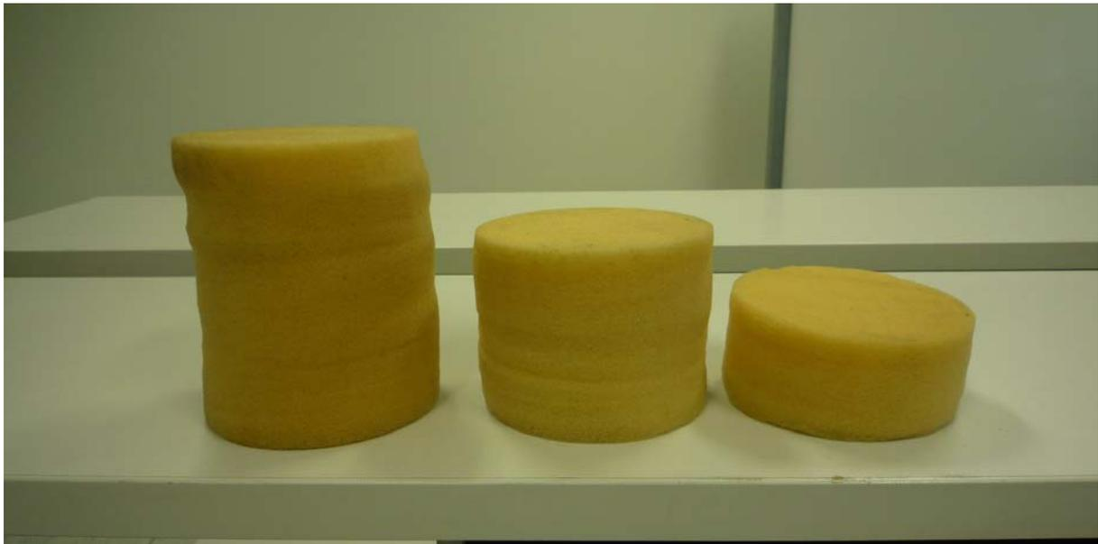
Die Absorber wurden zuerst mittels der 4- Mikrofonmethode einzeln vermessen. Anschließend wurden die Stärken 80mm und 120mm ausgehend von der Stärke 25mm simuliert.
