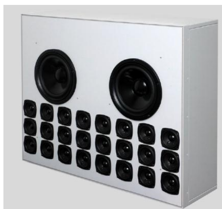
Abbildung 10: Lautsprecherchassis mit vertikaler Bündelung [7]
