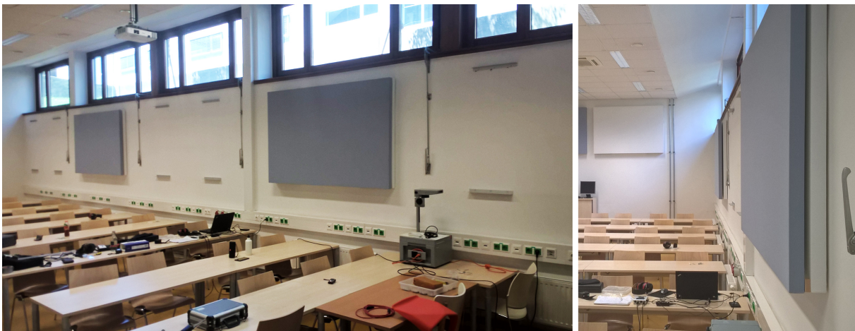
Abbildung 4.8: Absorberpositionierung 4 mit doppelten Absorbern
