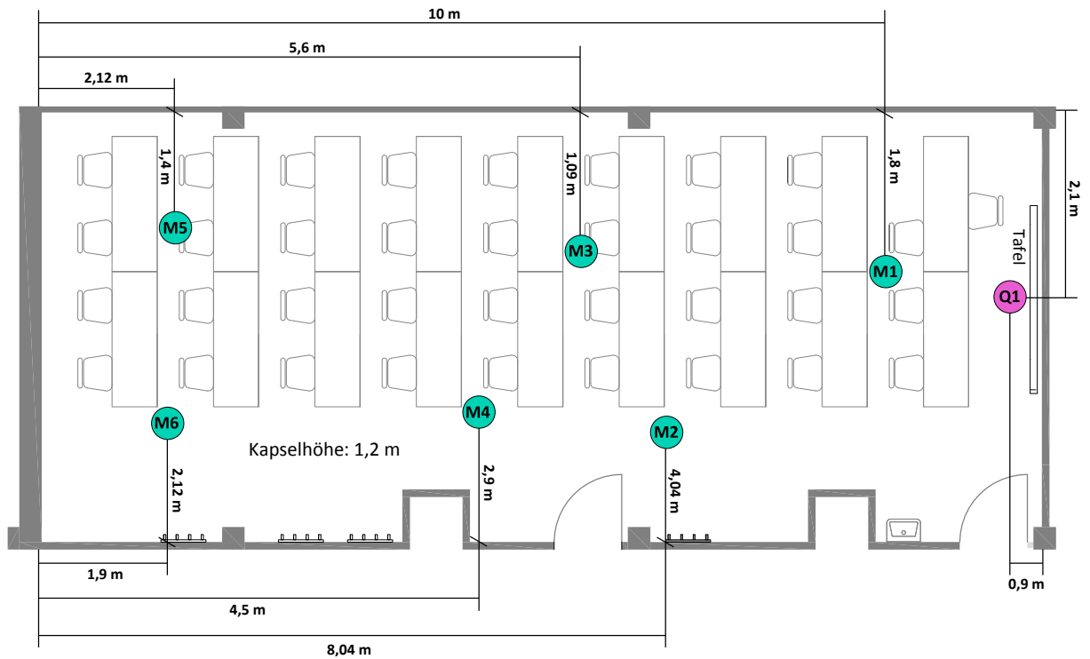
Abbildung 4.6: Quell- und Messpositionen der Nachhallzeitmessung
