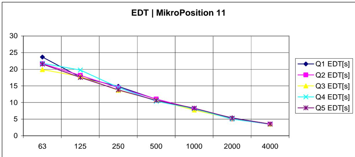
Abbildung 1-74: Early Decay Time für die Mikrofonposition 11 (Rasterpunkt 52)
