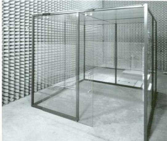
**Abbildung 2-43:** Die Besprechungskabine aus 10mm dicken Glaswänden mit den Abmessungen  $B=3,3\text{m}$ ,  $T=3,3\text{m}$ ,  $H=2,85\text{m}$ <sup>31</sup>
