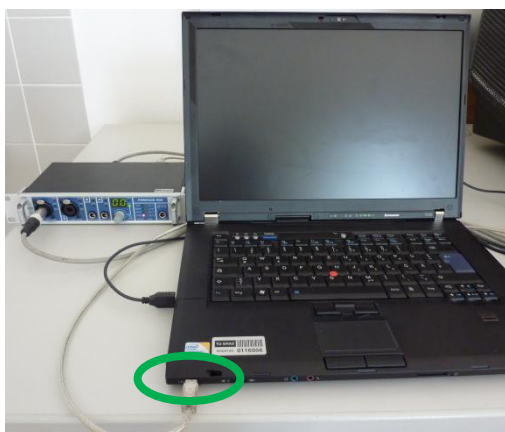
Abbildung 48: Anschluss des PC an das Audio Interface
