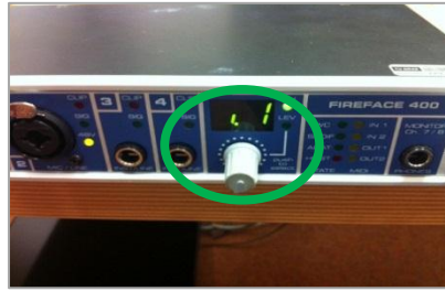
Abbildung 65: Auswahl des Kanals und Einstellung des Input Levels
