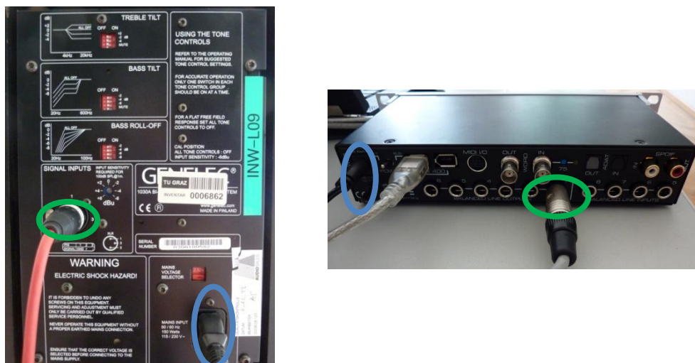
Abbildung 57: Verkabelung des Genelec1030A mit dem Audio Interface
