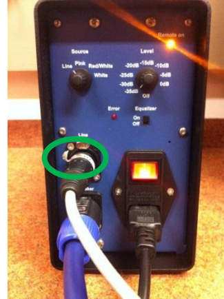
Abbildung 53: Anschluss des Dodekaederlautsprechers an den Verstärker
