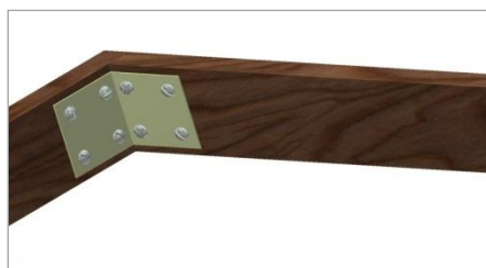
Abbildung 17: Verbindung der Rahmenelemente mit einem Winkel
