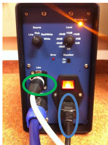
Abbildung 56: Anschluss des Verstärkers an das Audio Interface
