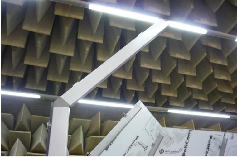
Abb. 107: Detailansicht Aufsteckrahmen mit Winkelstück 45°
