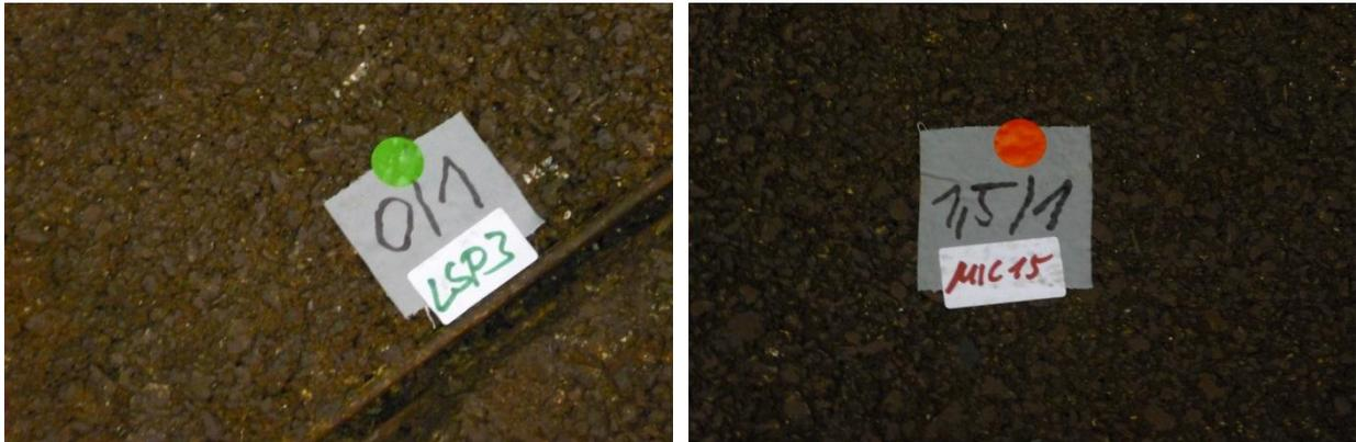
Abb. 102: Positionsmarkierung für Lautsprecher (links) und Mikrofon (rechts)
