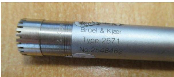
Abb. 98: ICP-Messmikrofon
