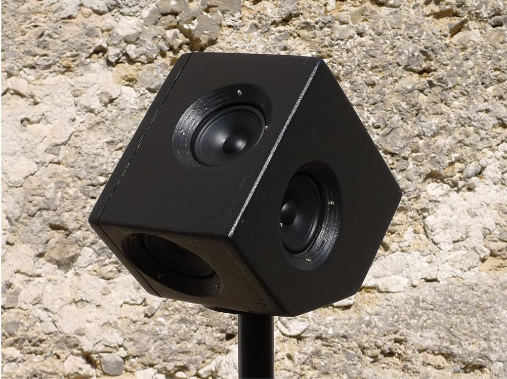
Abbildung 42: Kugelähnlicher Lautsprecher
