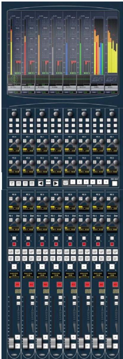
Jede Section beinhaltet ein hochauflösendes TFT Display welches Informationen über Metering und Bus Zuweisungen beinhaltet.
