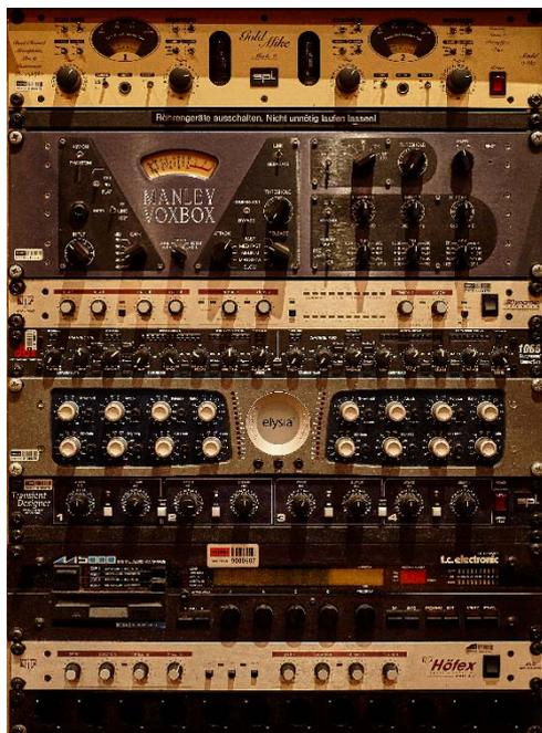
SPL Goldmike: 2ch Micpre mit schaltbarer Röhrenstufe
