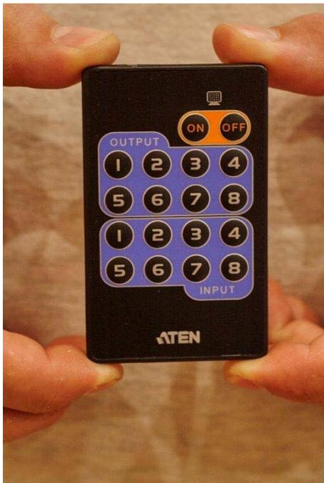
Abb. 1.25 Infrarot-Fernbedienung der HDMI Matrix
