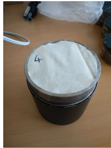
(b) Befestigung mit Klebebandstreifen
