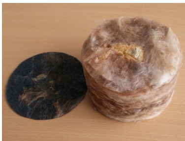
(a) Klebestelle der Vlieskaschierung auf einer Messprobe
