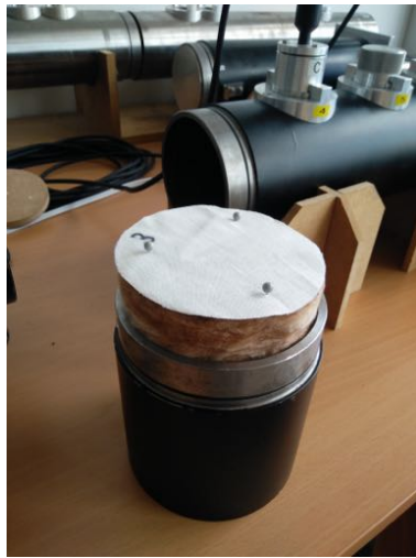
(a) Befestigung mit Stecknadeln
